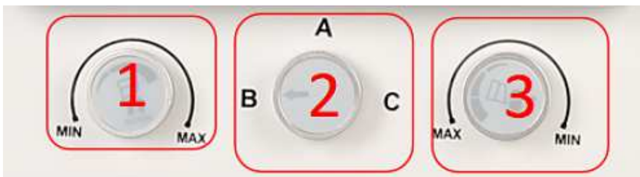
(1) regulace síly vakuového sání
